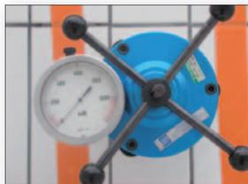
On effectue des essais d'arrachement de fixations et l'on détermine ainsi le type de fixation et la charge admissible pour le support donné.
