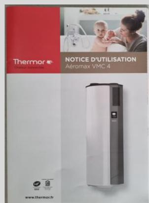
Le chauffe-eau sur air extrait est un produit qui associe les fonctions de ballon d'eau chaude sanitaire (ECS) et de ventilation mécanique contrôlée (VMC).
