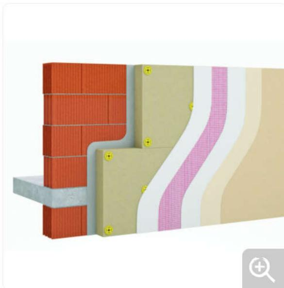
Système ITE avec isolant fibre de bois calé-chevillé et sous-enduit minéral à la chaux aérienne doté d'une multitude de choix de finitions : silicates, organiques, minérales minces et semi épaisses.
