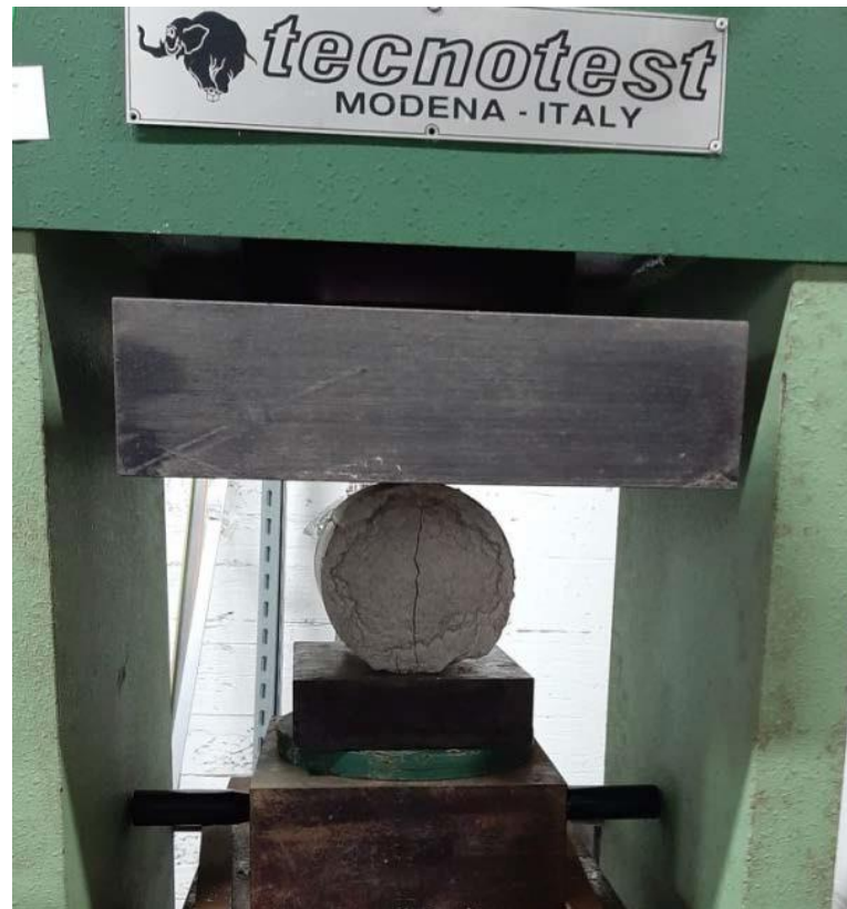
Figure 5. Rupture de l'échantillon à la fin de l'essai de résistance à la traction par fendage (essai brésilien).
