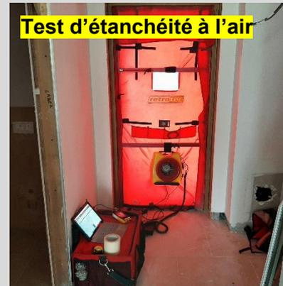
Test d'étanchéité à l'air
