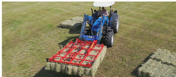
Chargeur frontal monté sur une fourche avant de tracteur
