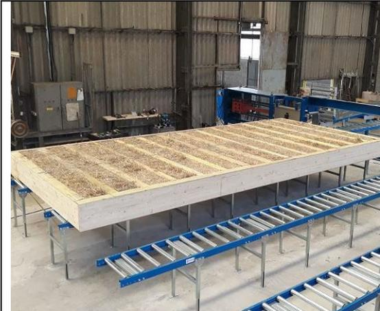
Le banc de fabrication est constitué d'une table d'assemblage des ossatures et d'un piston pour le remplissage avec des bottes.
