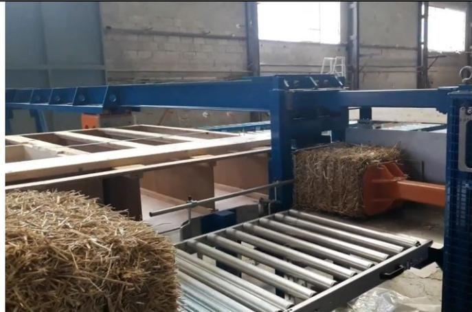
Le piston permet d'introduire en force les bottes de paille dans le caisson dont au minimum la face inférieure est fermée par des panneaux.
