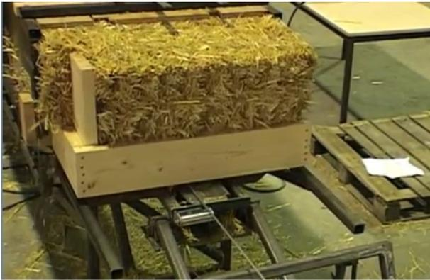
Une cage permet de comprimer dans les ossatures bois.
