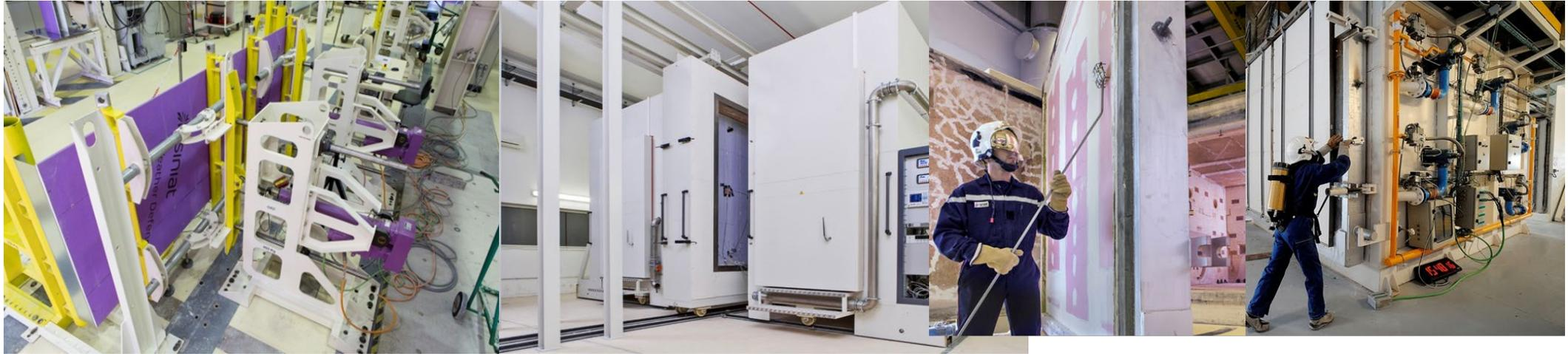
Le **Centre de Recherche & Développement Siniat** possède des installations permettant de faire des tests de **cloisons entières** selon les **normes** en vigueur : Feu (classification EI), Acoustique (dB), Mécanique (hauteur limite, impact), Thermo-hydrigue (résistance thermique). Une installation validée chaque année par le **CSTB**.
