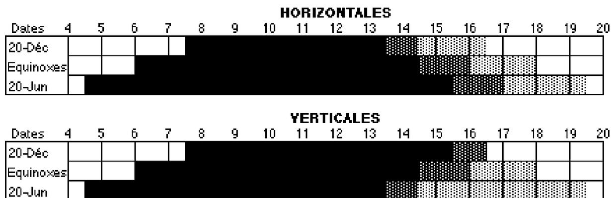
Figure 8 : Transmissions comparées des écrans à lames horizontales et verticales en orientation OUEST sous la latitude 43° Nord
