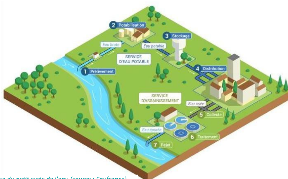
Figure 3 : Schéma du petit cycle de l'eau (source : Eaufrance)
