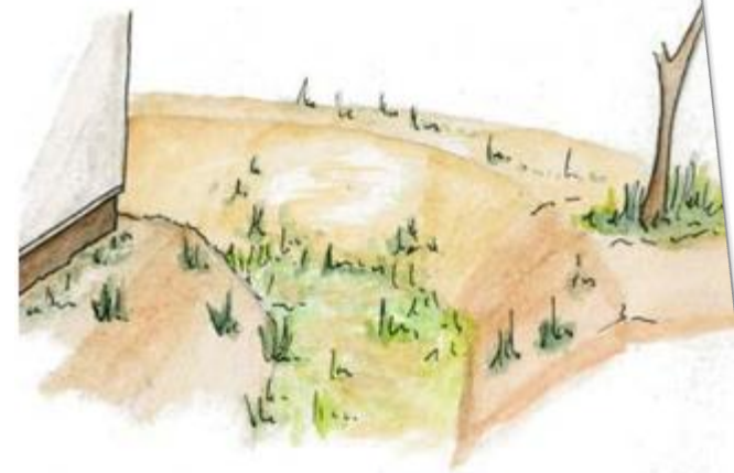
Ne se s'apparentant plutôt à une douve : berges trop raides, non plantée et mal intégrée.
