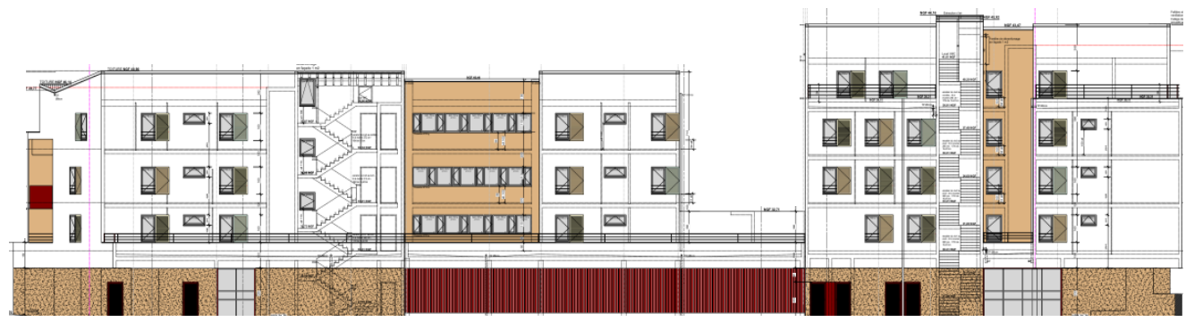
Paliers desserte étages éclairés et ventilés naturellement
