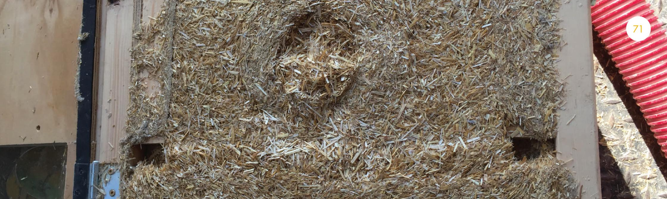
Sur la base du potentiel de la paille insufflée pour la rénovation du centre sportif de Tilburg, un échantillon d'ossature fut réalisé, de hauteur et de taille correspondant aux idées de départ pour ce projet. Cette ossature fut équipée de deux petites fenêtres et de deux entraves internes pour permettre la vérification de l'impact de ces éléments.
