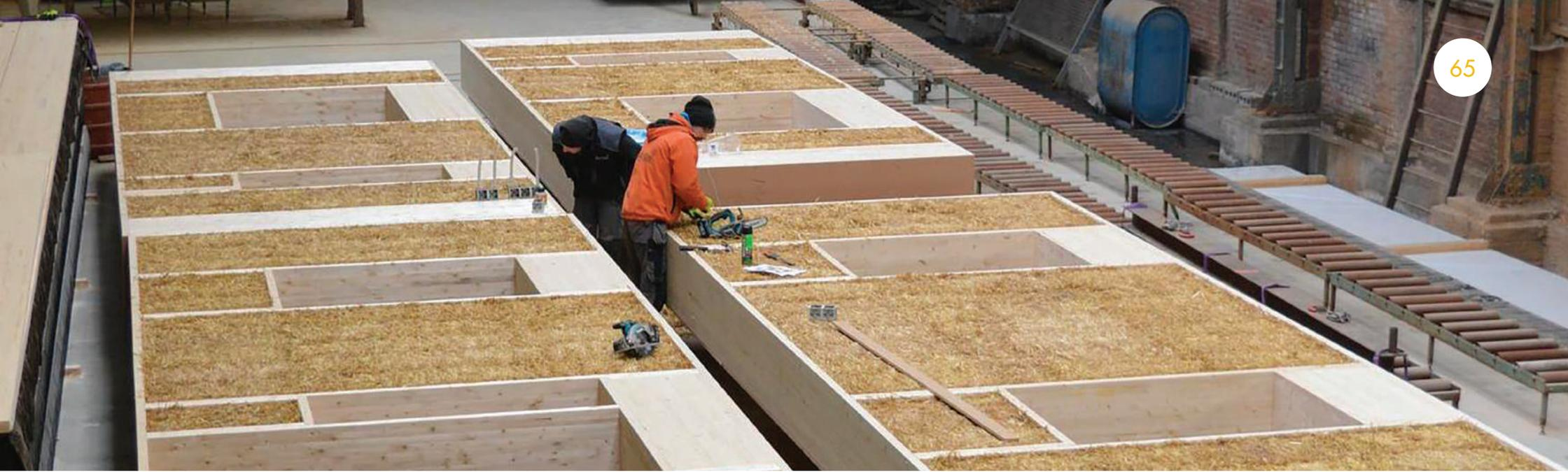
panneaux sont amenés sur site et assemblés sur site, l'enveloppe du bâtiment est réalisée en quelques jours.
