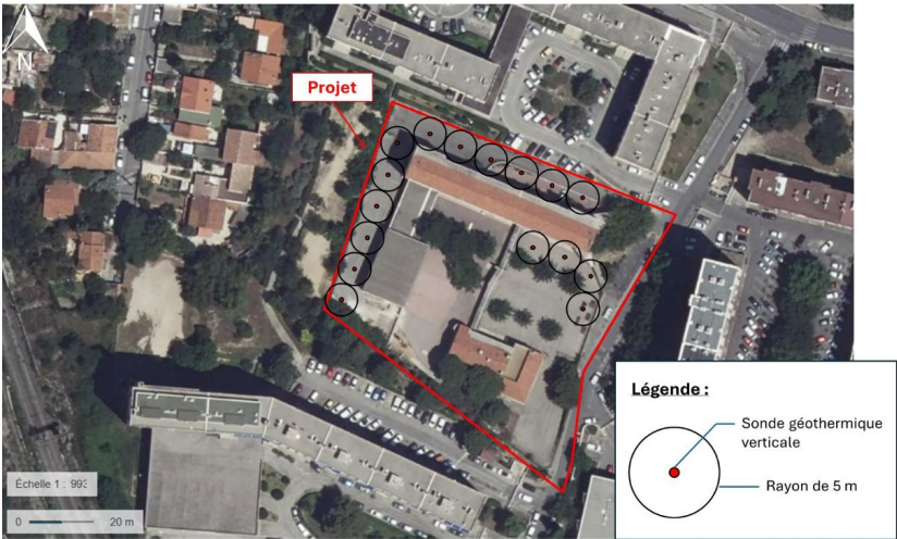
Figure 18 : Implantations prévisionnelles du champ de sondes envisagée au stade de l'étude de préféabilité (Source : GEOTHER)
