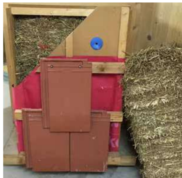
Figure 3: Systèmes de caissons remplis de paille fixés sur une façade en CLT pour l'immeuble Jules-Ferry, à Saint-Dié-des-Vosges. Le Toit Vosgien (Source : Architecte ASP – 18 rue St-Exupéry – 88100 SAINT DIE, BE thermique : TERRANERGIE – 1 Rue du Kemberg – 88100 SAULCY/MEURTHE)
