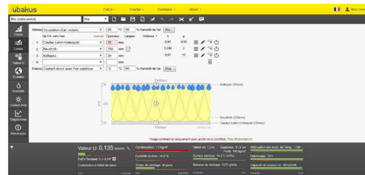
Composition de la paroi – Simulation Ubakus – Température extérieure -5°C
