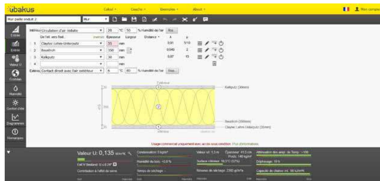
Composition de la paroi – Simulation Ubakus – Température extérieure +6°C
