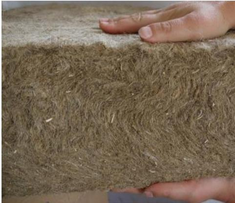
Remplacement de l'isolant en fibre de bois des murs par du **panneau de chanvre de l'entreprise Valtech** située à Veynes, à 10 km du chantier :
