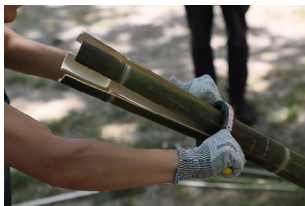
Démonstration de fente de bambou par Jean-Baptiste Dubois Rencontre "Construire en bambou et canne de Provence" organisée par EnvirobatBDM en mai 2026 - ©EnvirobatBDM
