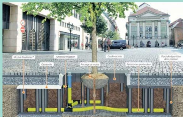
*Exemple d'un système de surveillance de l'irrigation et de la bonne reprise racinaire d'arbres plantés (source: Urbasense)*
