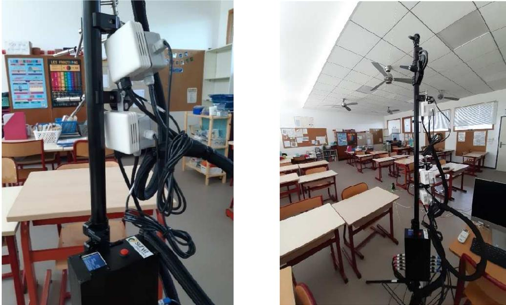
Figure 1 : Trépied de mesure de vitesse d'air Anémoma®
