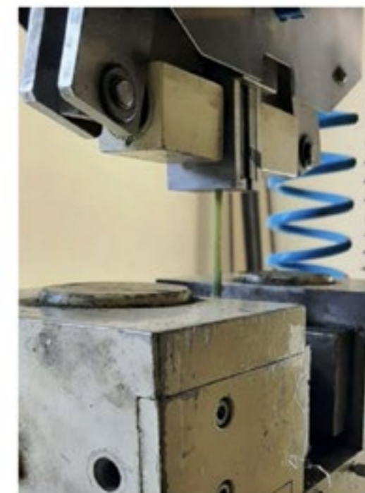
Figure 3. Tests de traction sur des fibres d' Arundo donax .
