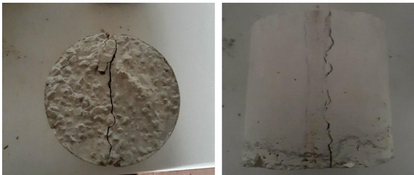
Figure 6. Rupture de l'échantillon, après application de la charge maximale, dans les directions transversale ( gauche ) et longitudinale ( droite ).
