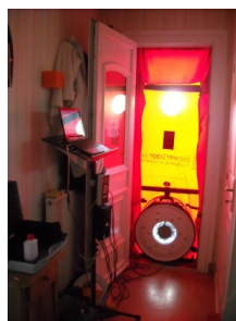
Réalisation du test d'étanchéité - Mai 2013
