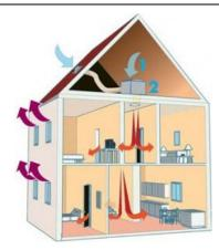
5 - Le rafraichissement par évacuation de la surchauffe par ventilation mécanique double flux (et utilisation du by-pass de l'échangeur)
