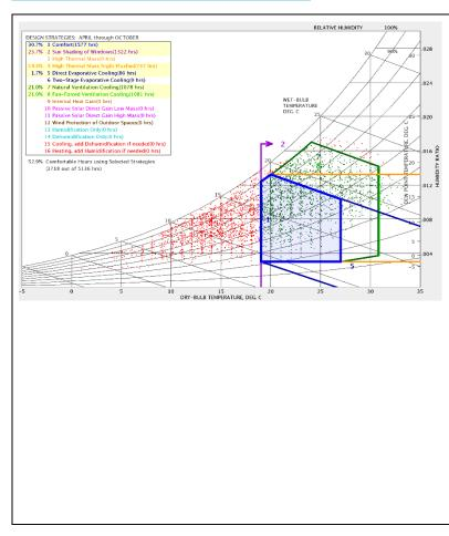
Le diagramme de Givoni, d'avril à octobre, pour Marseille, pour un été moyen, pour un logement protégé du soleil et avec des apports thermiques internes maîtrisés met en évidence heure par heure (un « . » par heure sur le diagramme) les températures et hygrométries permettant les zones de confort thermique suivantes :
