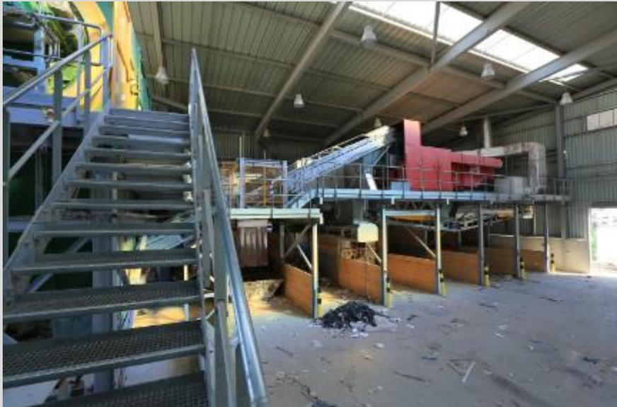
Pour les déchets non triés sur chantier, un tri soigné est réalisé dans le centre d'ECORECEPT. D'abord dégrossi à la pelle mécanique, puis un tri à la main est effectué séparant tous les types de matériaux (carton, plastique, polystyrène, consommables, ...)
