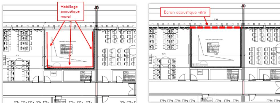
principe d'implantation des écrans acoustiques en rive de plateformes CTA
