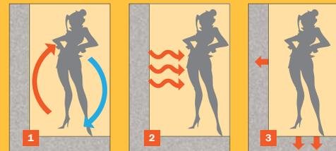
1 le phénomène de convection entre la peau et l'air 2 le rayonnement 3 la conduction par contact direct entre la peau et les objets
