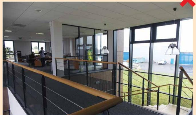
Les revêtements de type moquette et faux plafond réduisent l'inertie du bâti. La sur-ventilation n'est plus efficace
