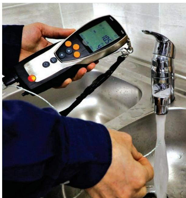
Thermocouple type K sur appareil multifonction enregistreur.
