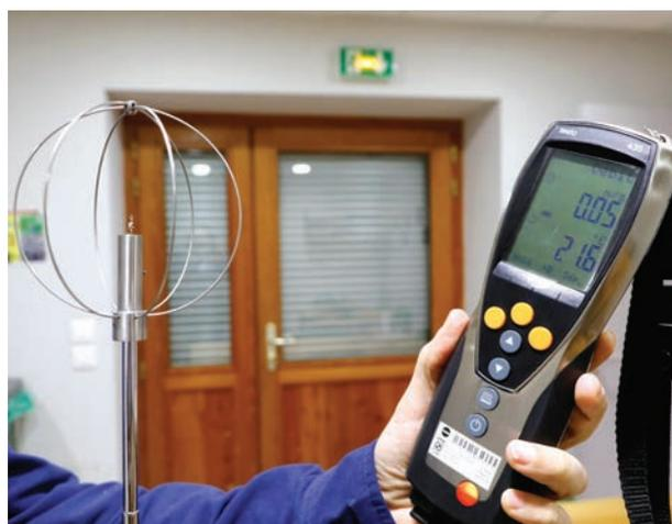
Anémomètre à fil chaud omnidirectionnel sur appareil multifonction enregistreur. @AQC
