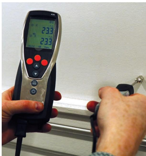
Thermomètre de contact sur appareil multifonction. @AQC
