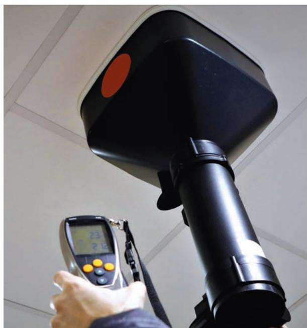
Anémomètre à hélices avec cône de mesure sur appareil multifonction. @AQC
