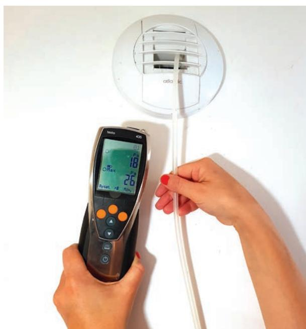
Capteur piézorésistif à mesure différentielle sur appareil multifonction. @AQC
