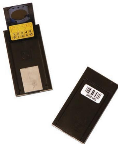
Dosimètre radon passif ouvert. @AQC
