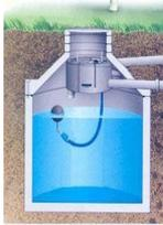
Dans le cas des pompes de surface, il est fortement conseillé d'aspirer l'eau par un tuyau souple équipé d'une crépine anti-retour et d'un ballon flotteur. Cette crépine flottante permet en effet de pomper l'eau sous la surface de l'eau, sans aspirer les saletés de surface ni le dépôt de fond...
