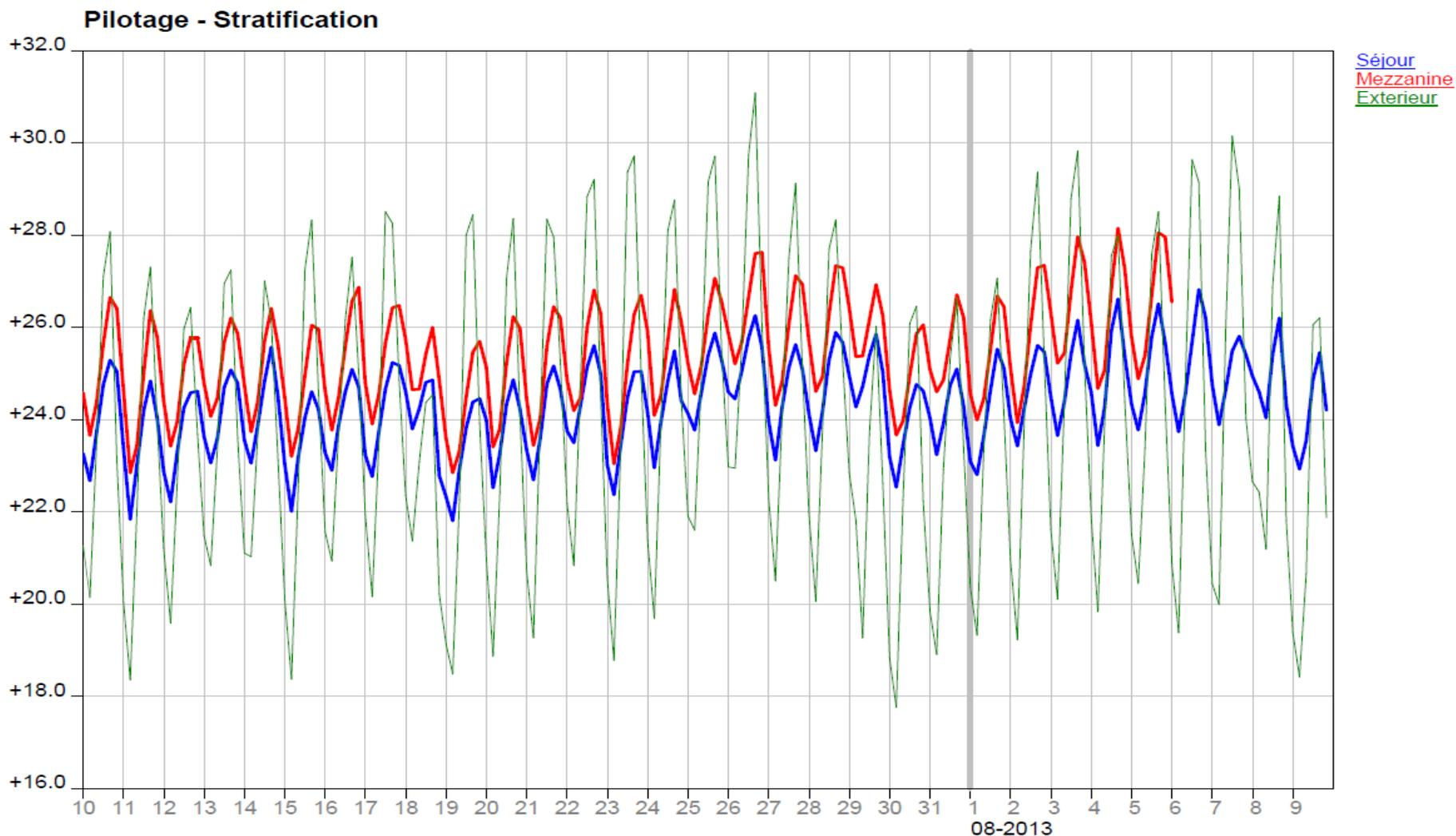
Sur la même période : on note que la stratification entre l'espace RDC/séjour et R+1/mezzanine (6m de hauteur sous plafond) est inférieure à 2°C.
