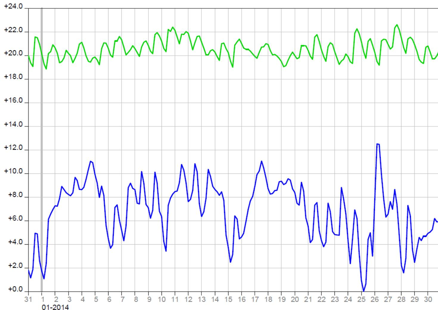
On remarque une grande stabilité dans une sinusoïde néanmoins cadencée par l'impact des apports solaires et internes ce qui induit une amplitude de l'ordre de 2°C.
