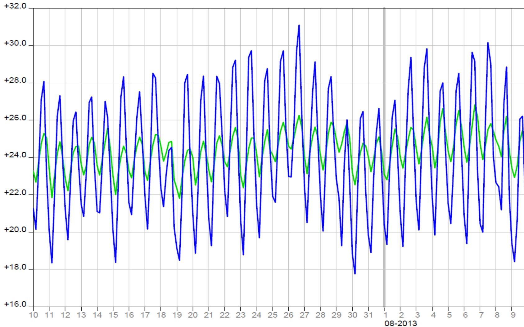
10/07 au 10/08 : L'efficacité du contrôle solaire et du rafraîchissement naturel permet une grande stabilité avec une amplitude de température journalière faible (2/3°C).
