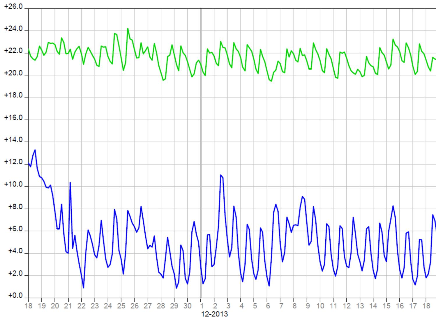
On remarque une grande stabilité dans une sinusoïde néanmoins cadencée par l'impact des apports solaires et internes ce qui induit une amplitude de l'ordre de 2°C.
