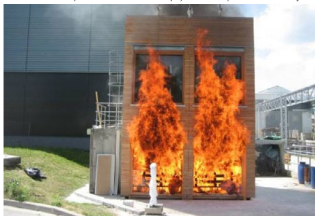
Essai feu dit "LEPIR 2" sur façade bois-paille © O.Gaujard
