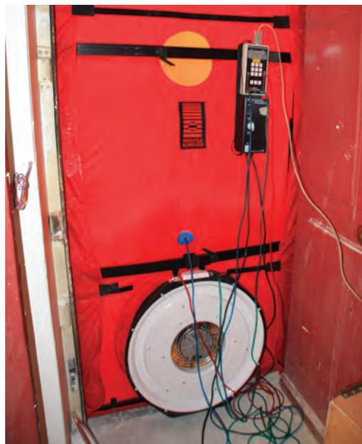
Porte soufflante lors d'un test d'étanchéité
