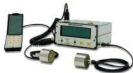
Équipement adapté à l'auscultation in-situ des briques pleines ; basé sur un concept acoustique, il donne des indications pertinentes sur la résistance des briques, en partant de la corrélation des vitesses de propagation du son à travers l'échantillon à sa résistance à la compression.
