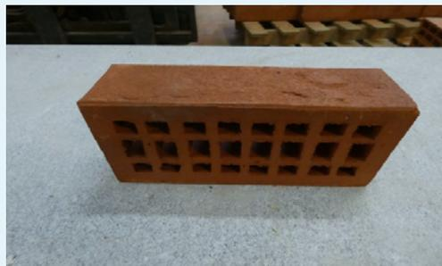
Photo n°4 : Brique U perforée (brique à perforations verticales)
