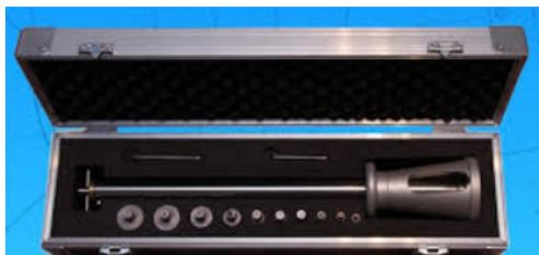
Cet outil donne une indication sur la dureté et la cohésion de surface des matériaux ; différentes tailles de poinçons existent, permettant d'adapter l'essai aux caractéristiques physiques des briques en place (cohésion, dureté de surface ...).
