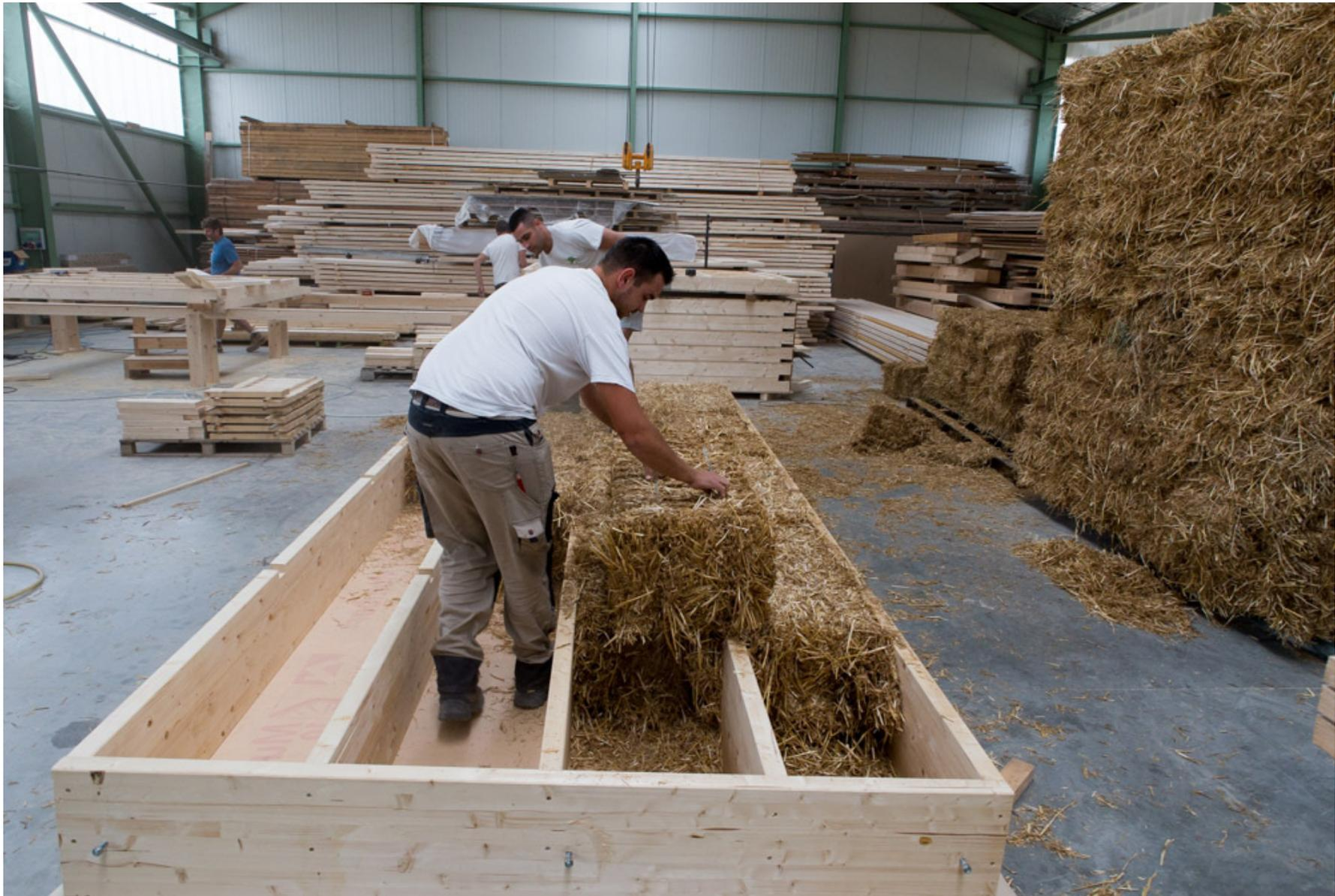
Mise en oeuvre de la paille isolante entre montants
