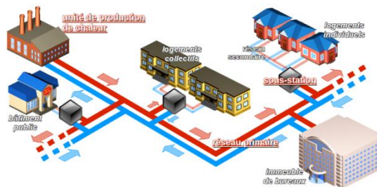
5. Schéma de principe réseau de chaleur urbain
