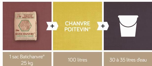
**Consommation indicative :** avec 1 m<sup>3</sup> de CHANVRE POITEVIN® et 10 sacs de Batichanvre® on réalise environ 950 litres de béton en place, en fonction du tassement (soit pour 1 m<sup>3</sup> de béton en place : 1 050 litres de chènevotte de CHANVRE POITEVIN® et 10,5 sacs de Batichanvre®.)
