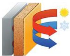
Le principe du mur manteau est simple : il consiste à entourer le bâti d'un manteau de protection hygrothermique.
