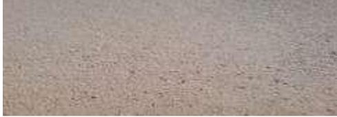
Ce procédé est un stabilisé constitué à 90 % de granulats naturels ou de sable de béton recyclé renforcé par un ciment de verre (10 %) à grains libres en surface.
